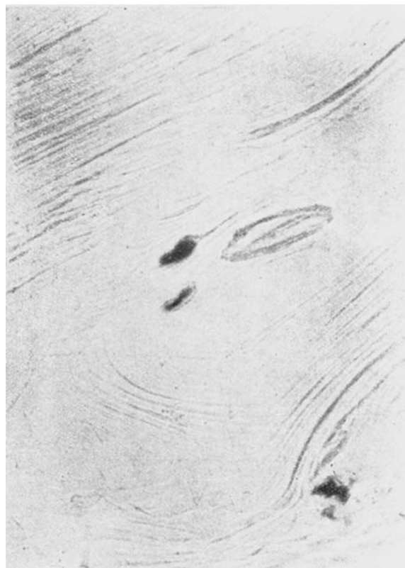
Abb. 6. Schlieriges Randschichtenglas mit Einschlüssen und einer länglich geformten Schlierenzelle.
