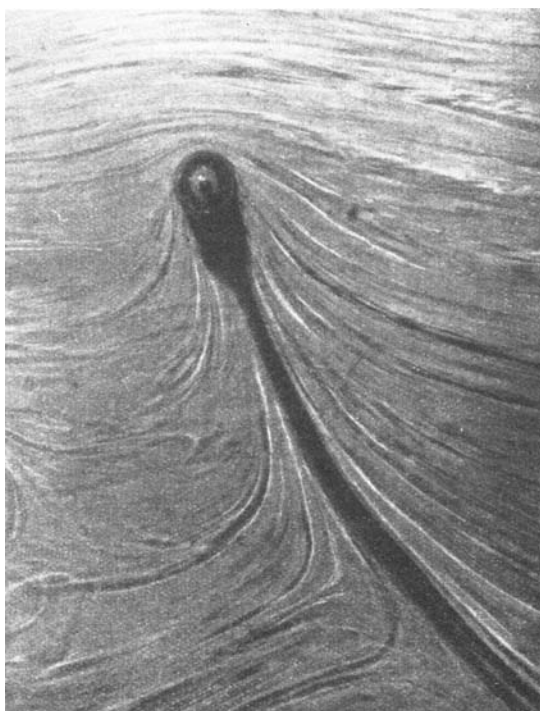
Abb. 3. In schlierigem Glasfluß aufsteigende Blasen. Ausformung der Schlieren. Färbung des Blasenwegs durch Eisenoxyd. (Schlauchbildung.) Etwa 5fach.
